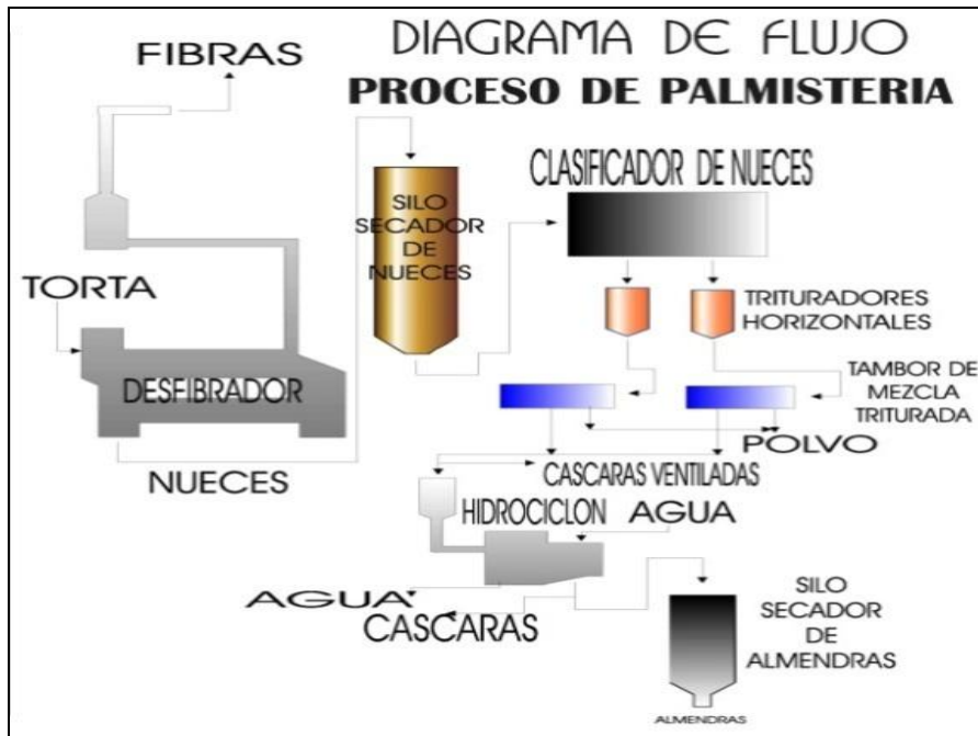
Figura 13: Diagrama de flujo de Palmisteria
