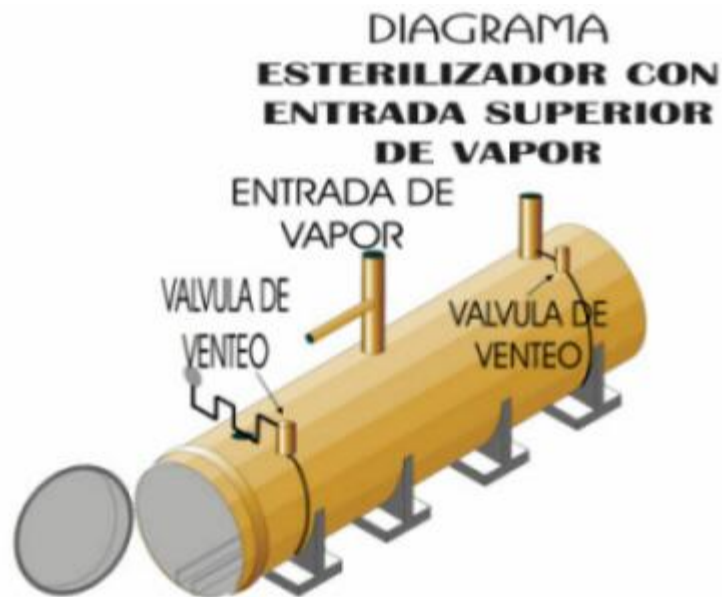
FIGURA 5: Esterilizador con entrada superior de vapor
