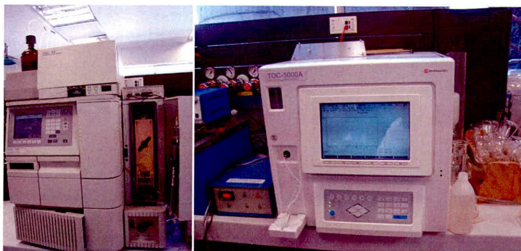
Figura 30. Medidores de HPLC y COT del Laboratorio de Estudios Ambientales de la Universidad de los Andes.
