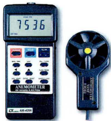
Figura 6. Anemómetro utilizado por la empresa INSPECTORATE para medir el caudal de las chimeneas
