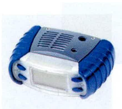
Figura 8. Analizador de gases Impact-Pro, utilizado para analizar la concentración de los gases estudiados
