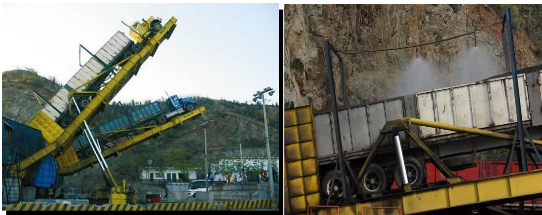
Imagen 1, Volcadores y sistema de aplicación del agente espumante AE-35
