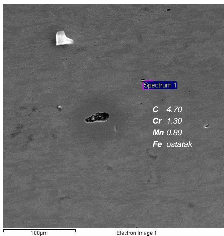
Slika 62. Segment šasije PODNICA uzorak 4: mjesto i rezultati EDS analize, OM1
