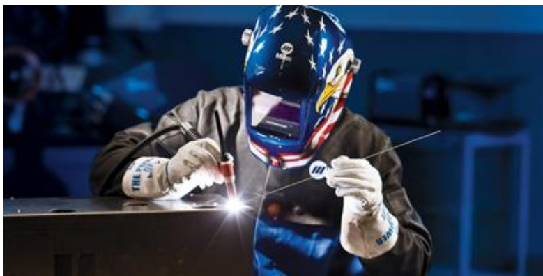
Slika 8. Postupak TIG zavarivanja cijevi [12]
