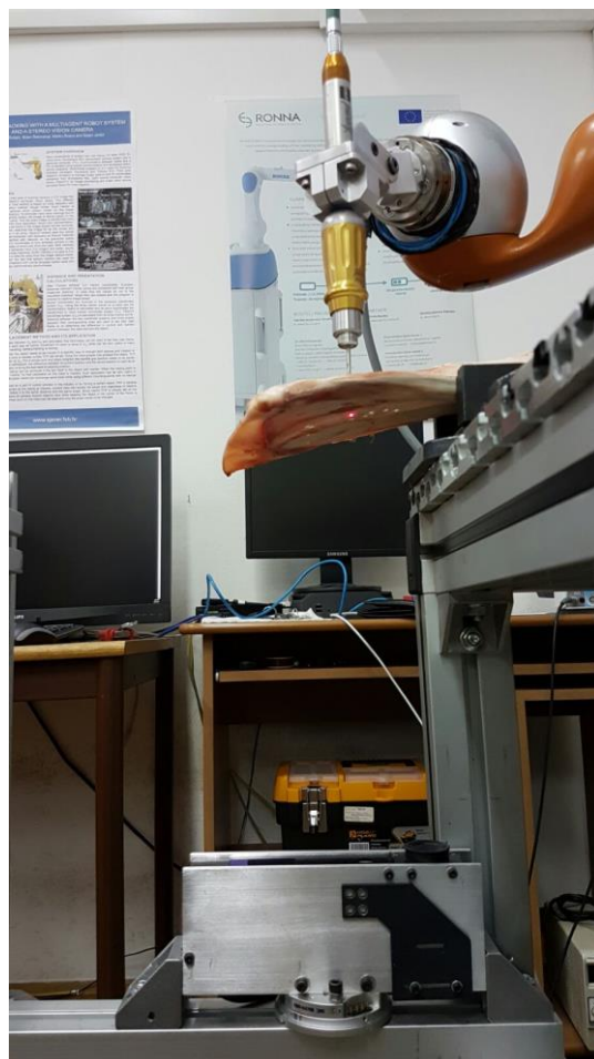
Slika 56. Kvantifikacija duljine hoda svrdla prilikom proboja
