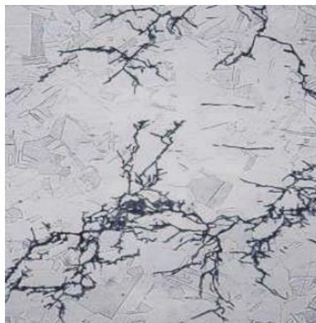
Slika 24. Transkristalna napetosna korozija AISI 316 čelika[25]
