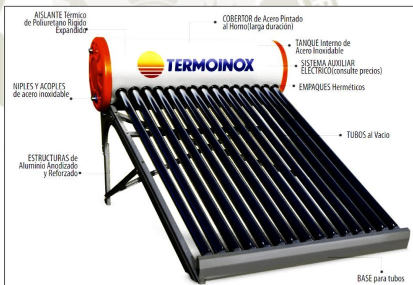
Figura N° 17. Partes del calentador solar de tubos evacuados.
