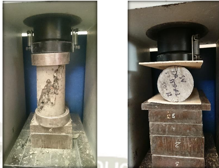
Figura 80: Compresión y tracción de probetas. Fuente: Elaboración propia.
