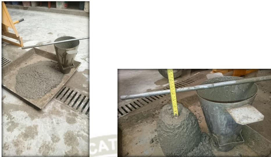
Figura 77: Revenimiento de muestras de concreto con nanoslice (izquierda) y optimizado con este aditivo (derecha). Fuente: Elaboración propia.
