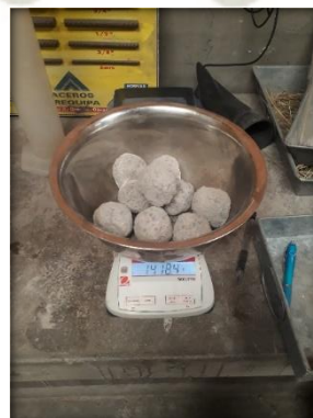
Figura 81: Ensayo de abrasión con cubos de concreto. Fuente: Elaboración propia.
