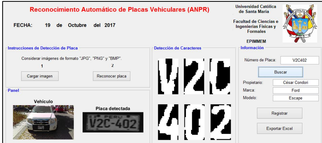
Figura 76. Pruebas del tercer programa con imágenes de vehículos Fuente: Elaboración Propia
