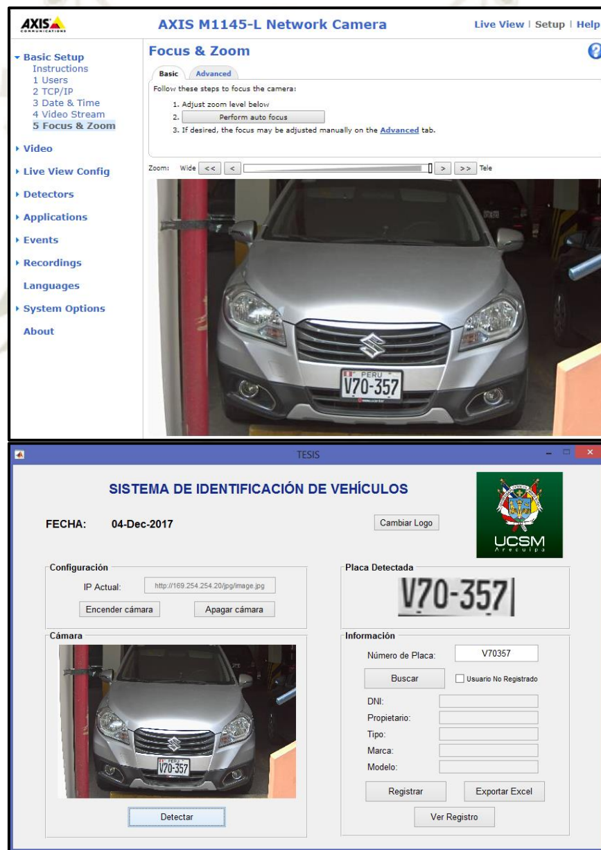
Figura 83. Detección correcta de la placa de un vehículo estacionado
