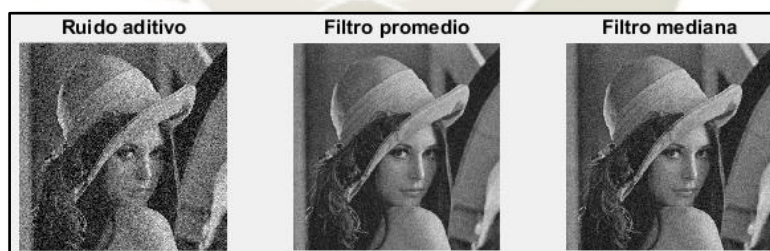
Figura 19. Filtros de paso bajo en una imagen con ruido gaussiano Fuente: Elaboración Propia
