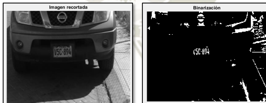
Figura 50. Imagen recortada y binarizada durante el pre-procesamiento Fuente: Elaboración Propia
