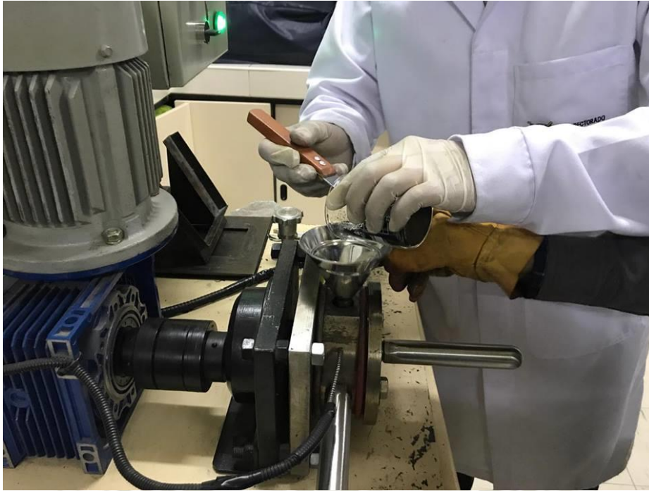
Figura 3- 38 Mezclado de Muestras de NTC y Pellets de PPpuro en el Equipo Brabender
