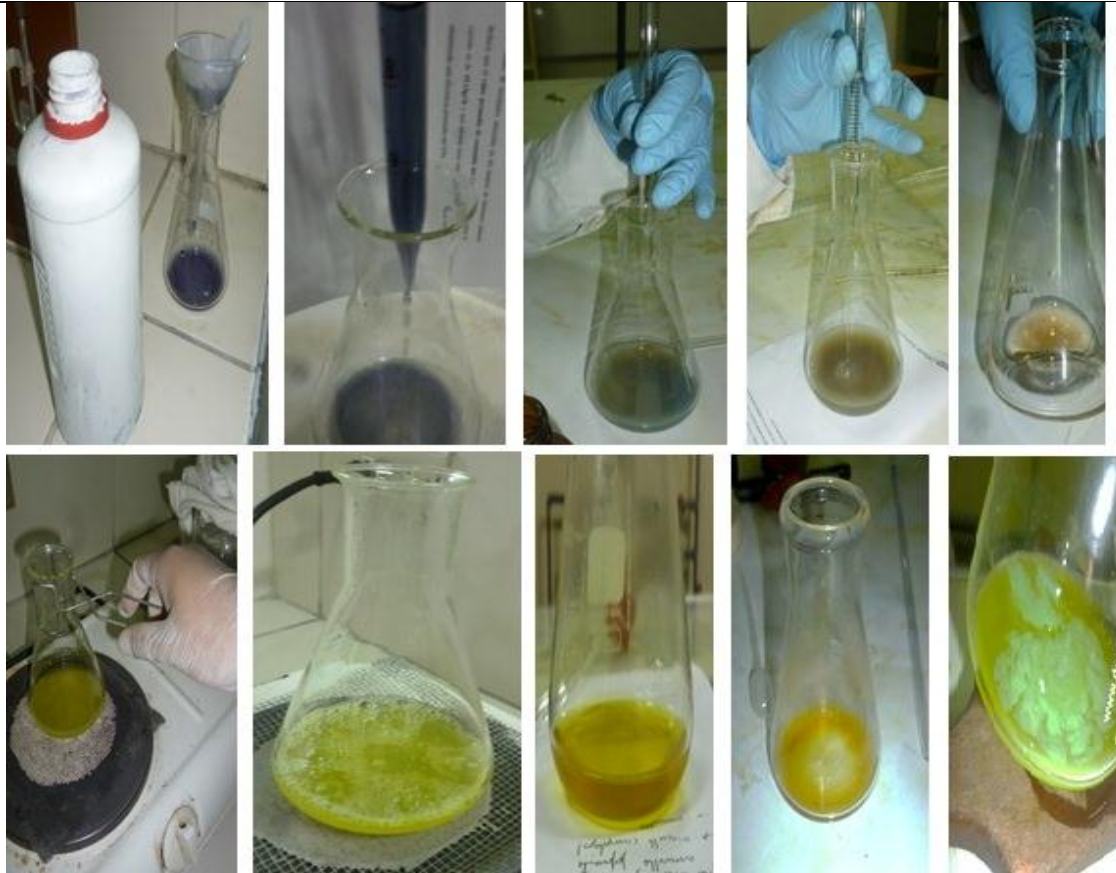
↘ Tratamiento de la muestra tomada, filtrado y determinación de su concentración de cromo total por el metodo yodometrico.
