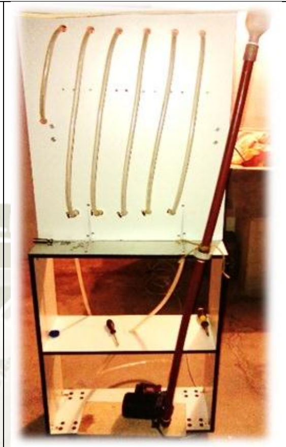
↓ Montaje del sistema continuo para la adsorción del cromo en agua residual de curtido (vista posterior).
