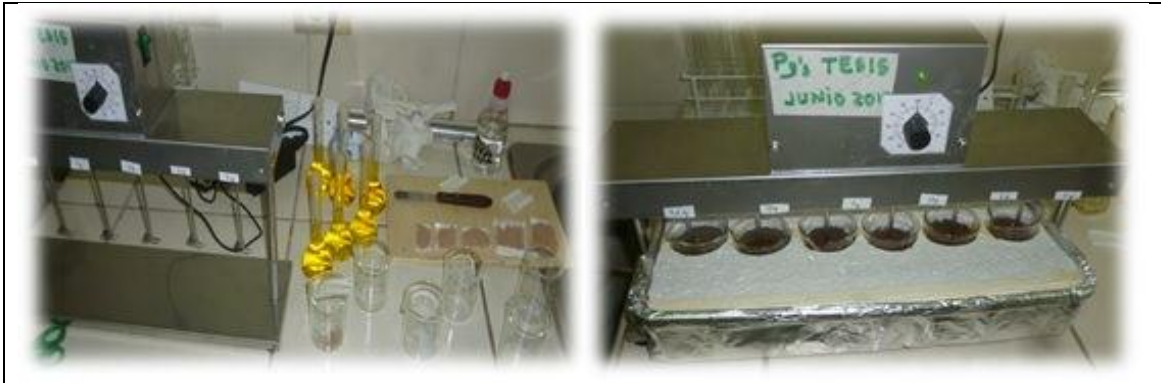
↘ Equipo de test de jarras para los ensayos en Batch, a la derecha se observa en funcionamiento.
