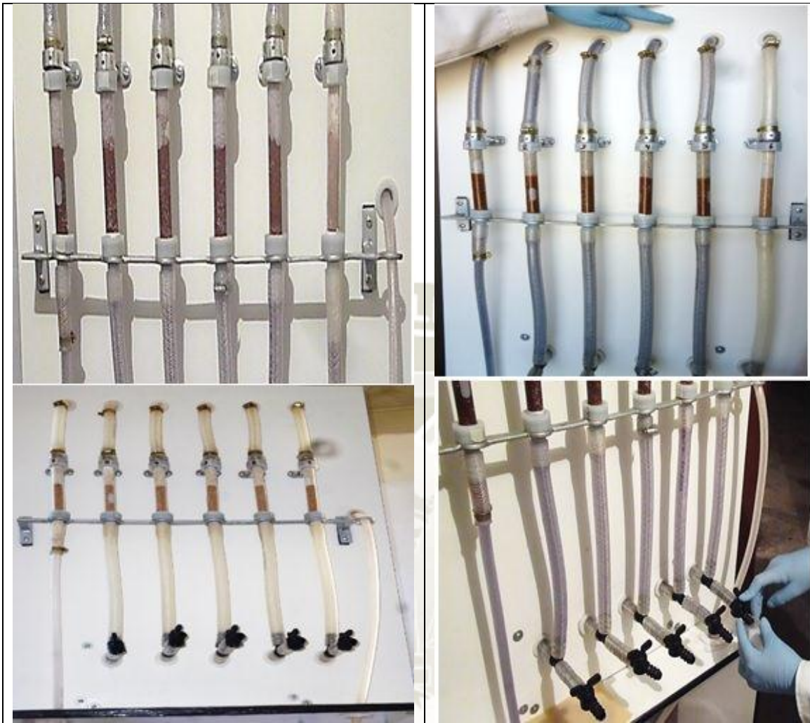
↘ Ensayos de adsorción de cromo en ARC en continuo y toma de muestras.
