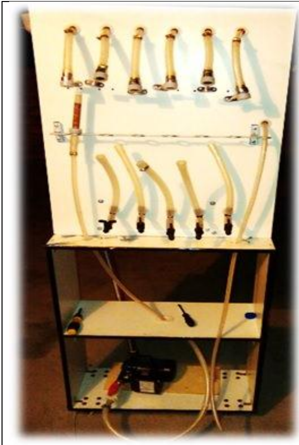
↓ Montaje del sistema continuo para la adsorción del cromo en agua residual de curtido (vista frontal).
