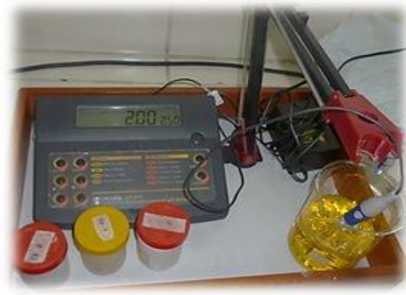
↓ Ajuste del pH a 2.0 de la solución de dicromato de potasio.
