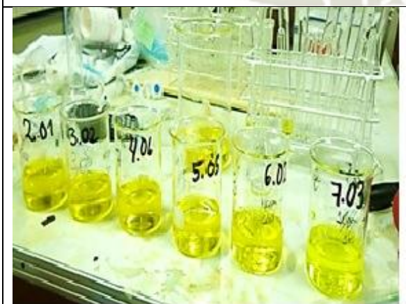
↓ Muestras de solución sintética con el pH regulado para la adsorción de cromo hexavalente.
