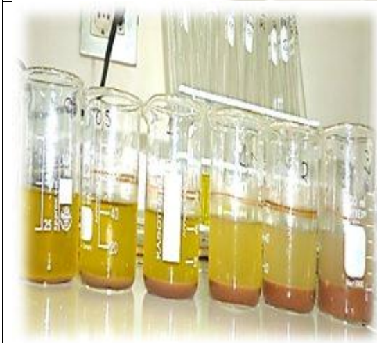
↘ Se observa los vasos con los ensayos luego del tratamiento de biorremoción de cromo con SDP, a la derecha se aprecia luego de la filtración.
