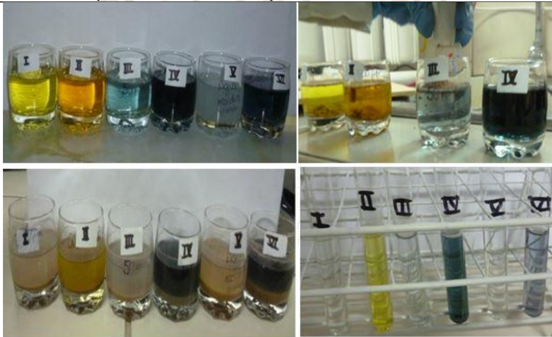
↘ Ensayos de adsorción de cromo (VI) para la determinación de la cinética en batch.
