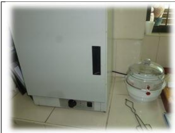
↓ Determinación de la humedad, por peso constante de la semilla en la estufa de laboratorio.
