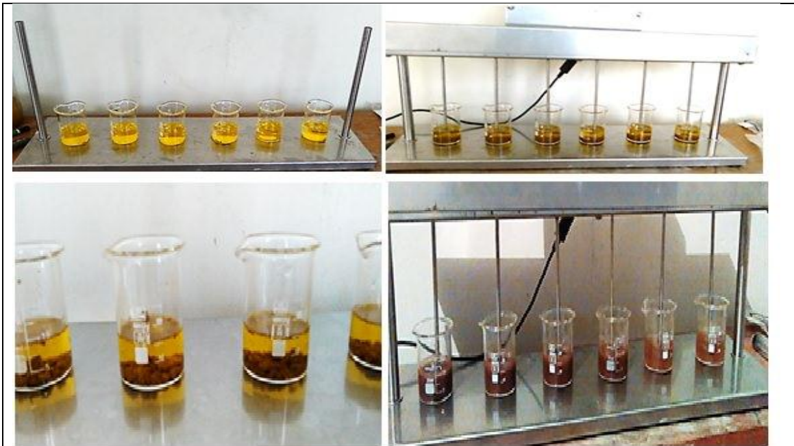
↘ Ensayos de adsorción de cromo (VI) para la determinación de la cinética en batch.
