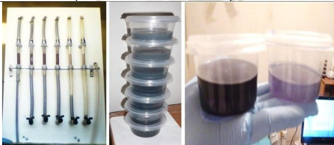
↘ Ensayos de adsorción de cromo en ARC en continuo y toma de muestras, en la foto del medio se aprecia las muestras tomadas, y en la foto derecha se muestra una comparación de cualitativa entre la muestra que ingresa (más oscura) y la muestra que sale del sistema (más clara).
