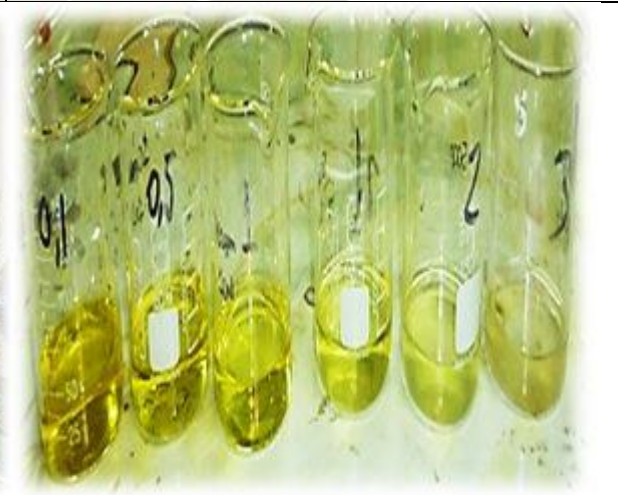
↘ Se observa los vasos con los ensayos luego del tratamiento de biorremoción de cromo con SDP, a la derecha se aprecia luego de la filtración.
