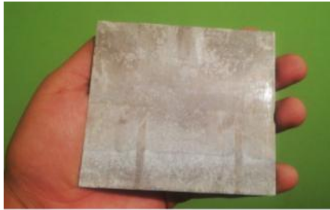
Figura 16: Formación de óxido en los electrodos debido al tratamiento de electrocoagulación
