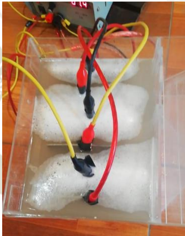
Figura 15: Formación de burbujas durante el tratamiento de electrocoagulación
