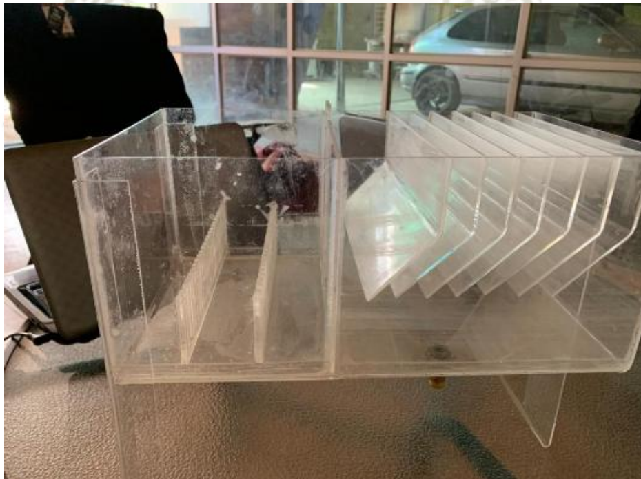
Figura 14: Sistema de electrocoagulación, vista lateral
