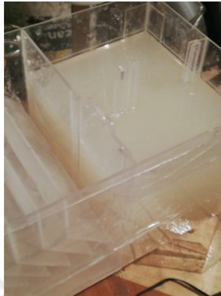
Figura 12: Operación del sistema de tratamiento convencional de coagulación – floculación
