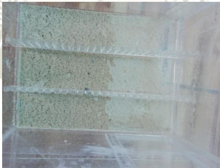
Figura 17: Flóculos formados y sedimentados en el tratamiento de electrocoagulación
