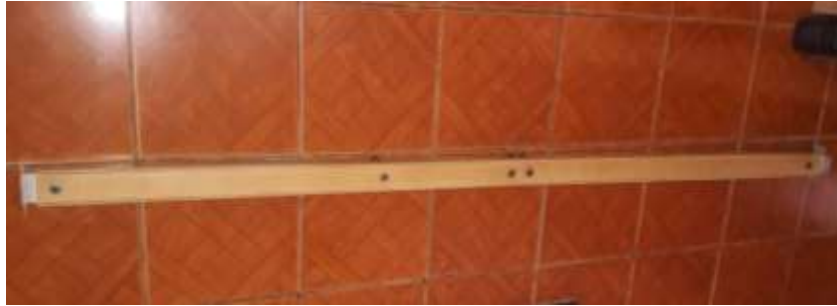
Figura 4.1 Columna de aluminio y madera(MDF)
