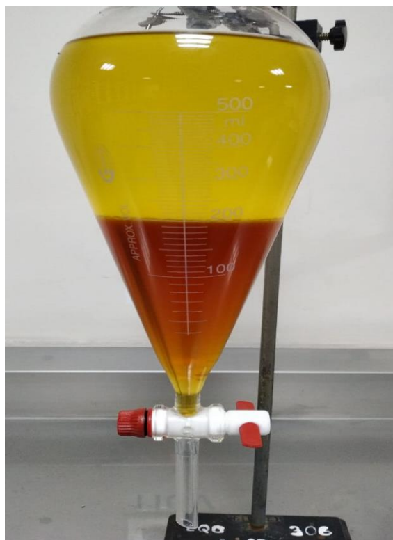
Figura 2.8 Separación del biodiésel de palma
