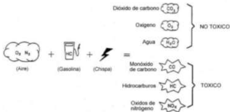
Figura 19. Combustión de la mezcla y emisión de gases del vehículo (Meganeboy, 2014).
