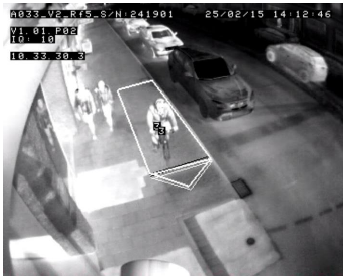
Slika5. Računalni vid sustava FLUX u Darmstadtu
