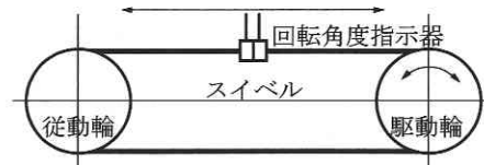
図6 ケーブル捻れ試験：スィベル部分を両輪間で往復させて回転角度指示器の振れを読みとる
