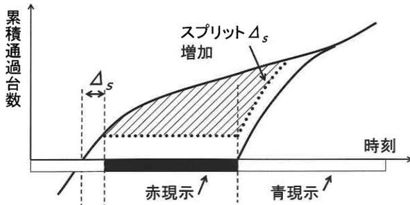
図2 遅れ時間の変動 (スプリット変更時)
