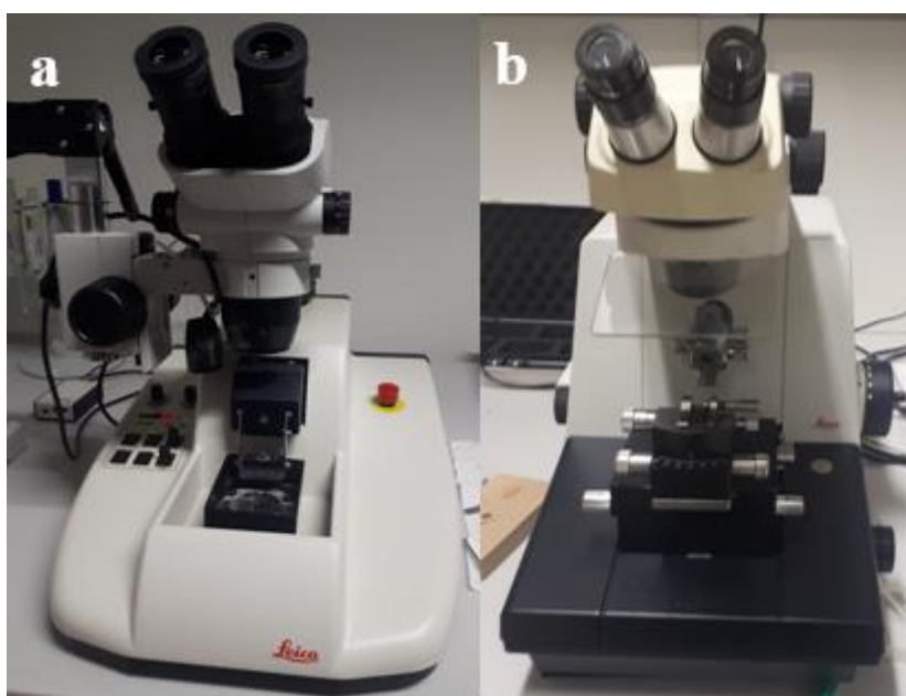
Slika 3.4.4.1. Uređaji za rezanje uzoraka: Vibratome (a) i Microtome (b)
