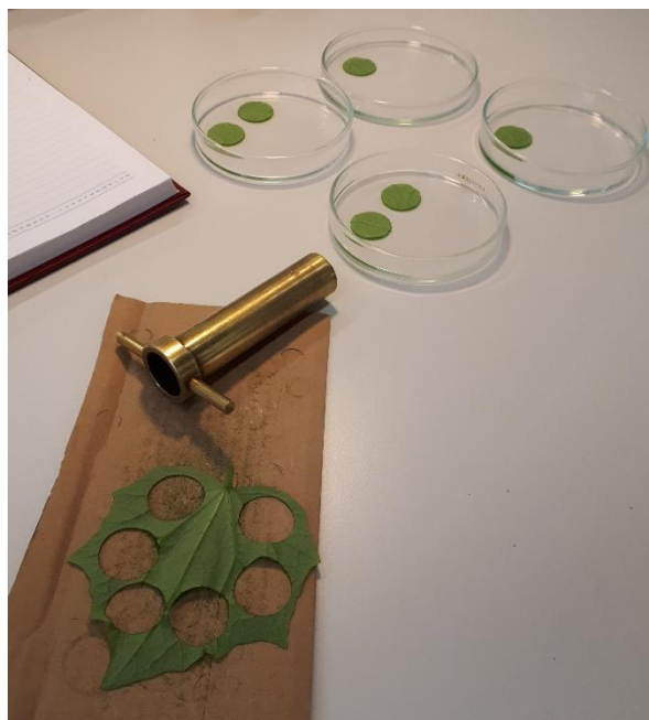
Slika 3.4.1.1. Kružni bušać za rezanje uzoraka listova
