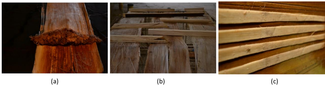
Figura 25. (a) alistamiento de la pared externa, (b) secado, (c) corte de cintas
