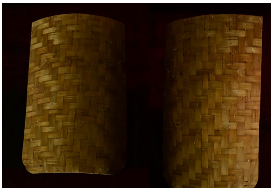
Figura 69. Teja elaborada con fibras de pseudo tallo de plátano
