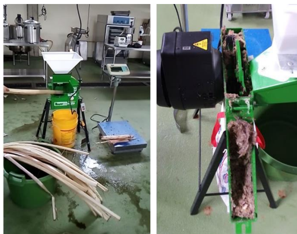
Figura 20. Triturado de calcetas, atrapamiento de fibras.
