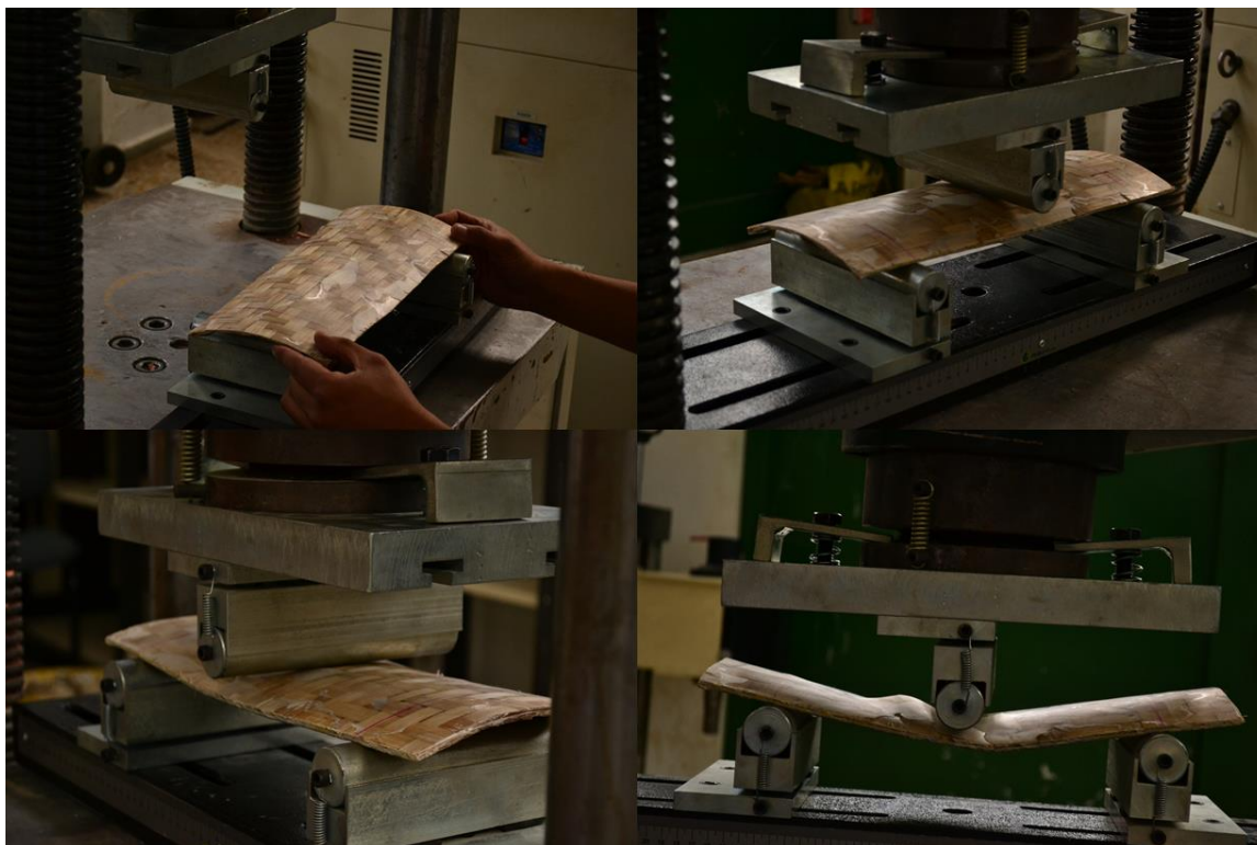
Figura 70. Prueba de la teja en Maquina Universal de ensayos
