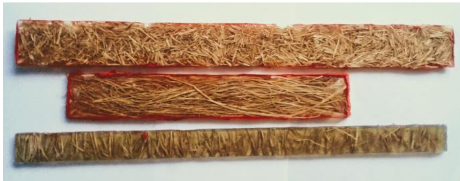
Figura 19. Probetas con refuerzo unidireccional y refuerzo discontinuo.
