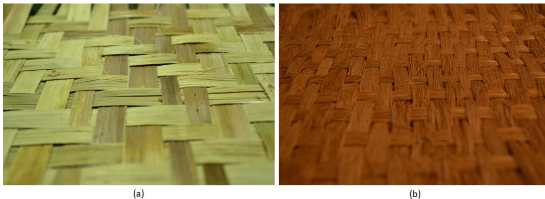
Figura 66. (a) tejido cruzado con cintas, (b) tejido simple con fibras
