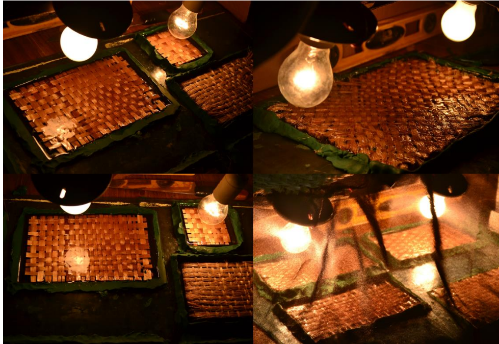
Figura 37. Probetas en proceso de curado.
