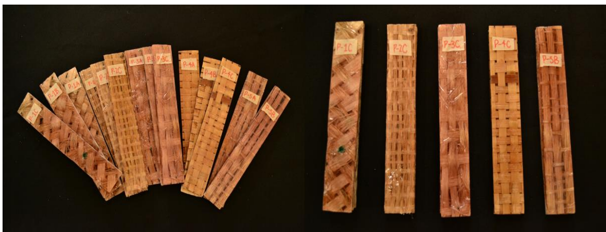
Figura 38. Probetas norma ASTM 3039
