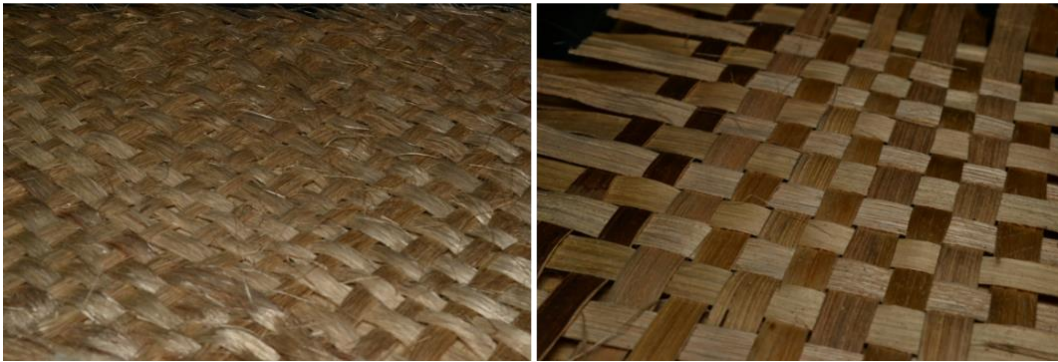
Figura 33. Elaboración de tejidos para producción del material compuesto.
