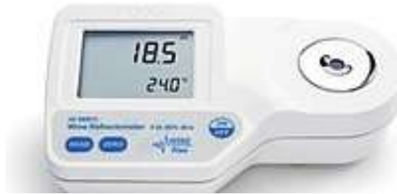
Figura 11. Refractómetro de alimentos HI 96811 donde se realizó la determinación de sólidos solubles.
