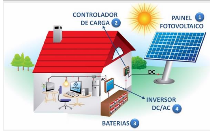
Figura 3: esquema residencial de energía solar
