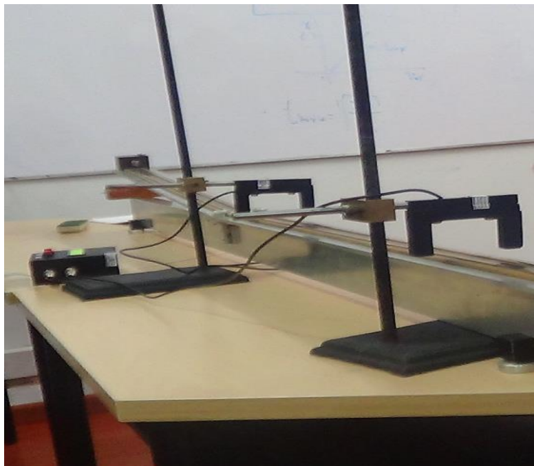
Figura 6. Montaje experimental para un MRU fuente: elaboración propia
