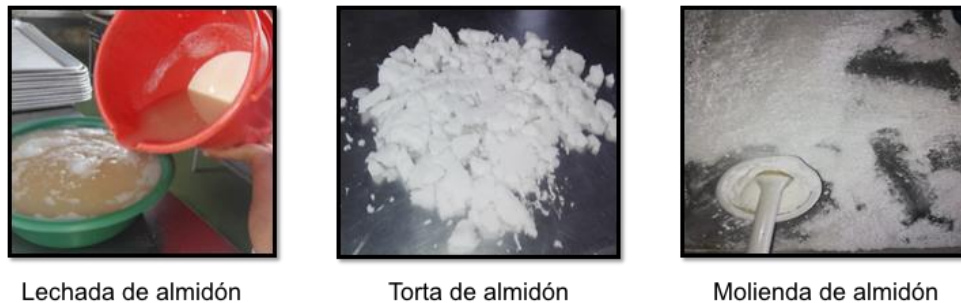
Figura 10. Productos obtenidos en las etapas del proceso de extracción de almidón.
