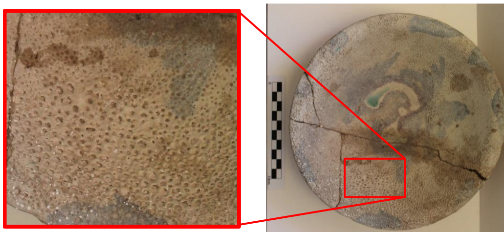
Ilustración 2.37 Plato con defectos de poros en la Colección de la Escuela Taller- Castillo San Felipe. Archivo personal (2019)
