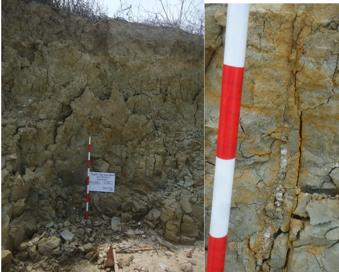
Ilustración 7.17 Perfil estratigráfico de Barro de Loza 2 y su detalle de sales acumuladas
