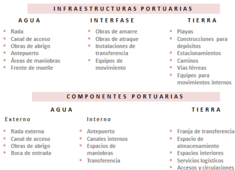
Figura 49: Infraestructuras y componentes portuarios
