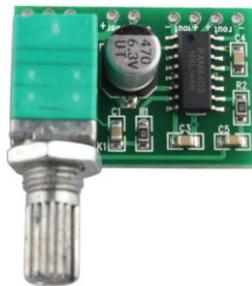
Fig. 5. Amplificador de audio PAM8403 clase D de 3W.
