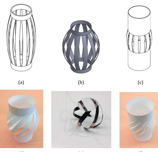
(d) (e) (f) Fig. 7.4 Tubular Cylindrical/Helical silt IPMC actuator/sensor.
