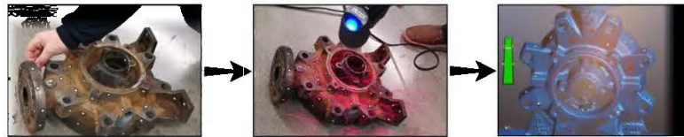
Figure 76 : Scanne 3D de la pièce décharge
