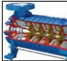
Figure 80 : Les stages de transmission de la pompe
