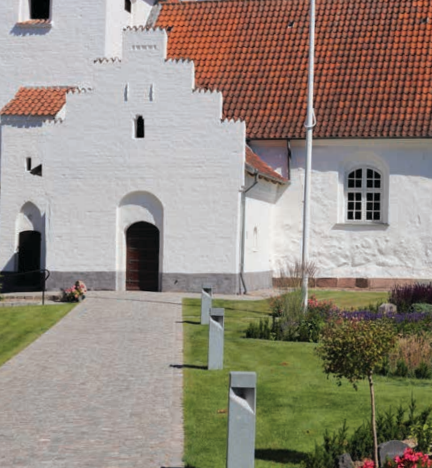
Hvor der før var dækket med perlesten og en sti af betonsten, er der nu chaussésten med brede græsrabatter. Gravstederne er nyomlagte og tilplantet med stauder.
