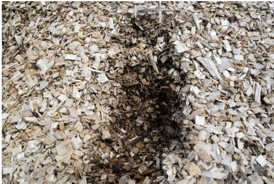
Foto 15: Lys, tør flis yderst og mørk, fugtig flis inderst i stakken.
