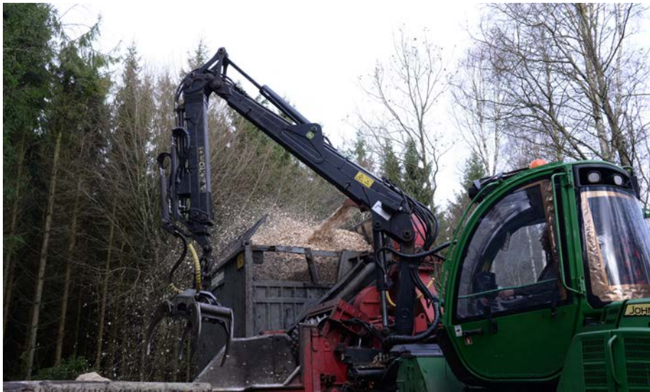
Foto 14: Poppelstammer flises. Der udtages løbende prøver af flisen.
