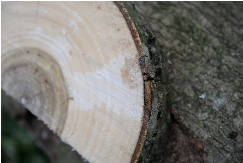
Foto 9: Skive fra poppelstamme. Bemærk, at bruddet i barken har medført en lokal udtørring af splinten.
