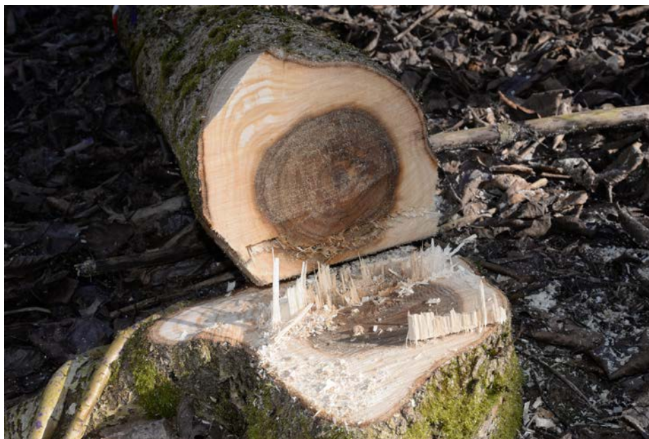
Foto 8: Poplernes splint er lys og kernen er mørk. Kernen har en lavere massefylde og et højere vandindhold end splinten.
