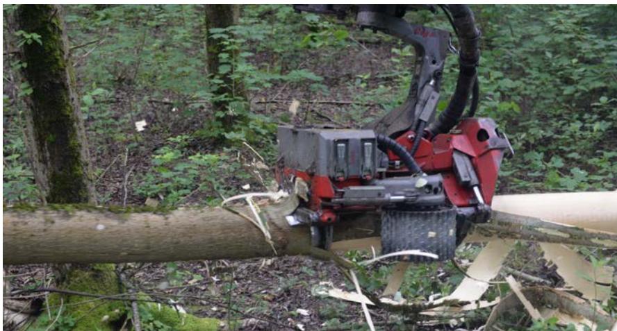
Foto 2: Fældning og afgrening og i dette tilfælde også afbarkning
