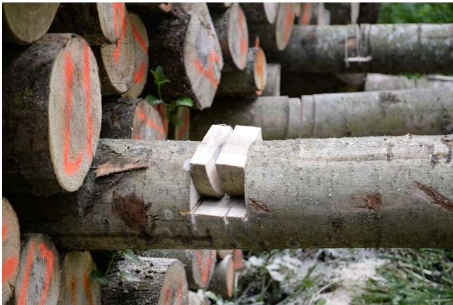
Foto 6: Udsavede skiver fra prøvetagningen på lagrede poppelstammer. Én prøve deles i splint og kerne og én prøves tørres hel.
