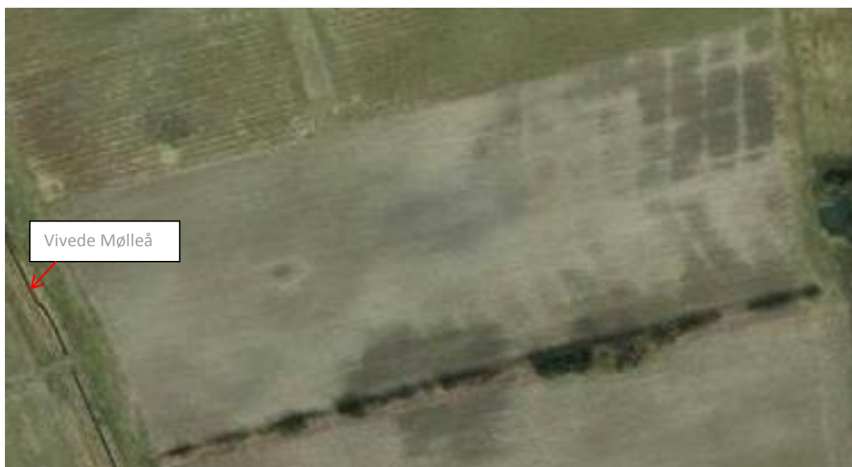
FIGUR 5. FORÅRSSITUATION I FORSØGSMARK VED TOKKERUP MED LILLE TERRÆNHÆLDNING. BILLEDET ILLUSTRERER, AT DE VÅDESTE OMRÅDER I MARKEN FINDES LÆNGST VÆK FRA RECIPIENTEN (VIVEDI MØLLEÅ) OG MELLEM DRÆNENE. DRÆNENE I DETTE OMRÅDE LIGGER TÆTTERE PÅ OVERFLADEN FOR AT OPNÅ DET NØDVENDIGE FALD, OG GRUNDVANDET UNDER I DENNE DEL AF MARKEN STÅR STADIG OVER DRÆNNIVEAU. [LUFTFOTO AF UKENDT OPRINDELSE, PRÆSENTERET I HANSEN OG JENSEN (2013)].
