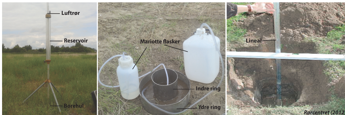
Figur 1. Metoder til måling af mættet hydraulisk ledningsevne, som alle er velegnet til LAR. Fra venstre: Guelph-permeameter, dobbelt-ring-infiltrometer (constant head-metode) og nedsvivningshul. Målearealet, og dermed den geologiske uensartethed, som hver metode tager højde for, stiger fra venstre mod højre. Til gengæld går målingerne hurtigere og bruger mindre vand fra højre mod venstre.
