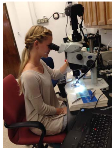
Figur 5. Undertegnede foran setuppet bestående af stereomikroskop med monteret Nikon D800 kamera, med hvilket videooptagelser blev foretaget.
