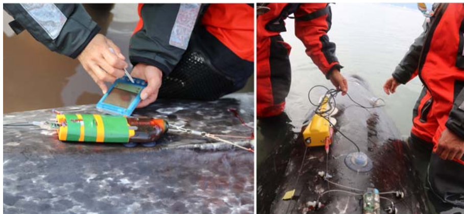
Figur 4. Narhval instrumenteret med akustisk rekorder (til venstre) og med hjerteslagmåler elektroder i sugeskopper (til højre).
