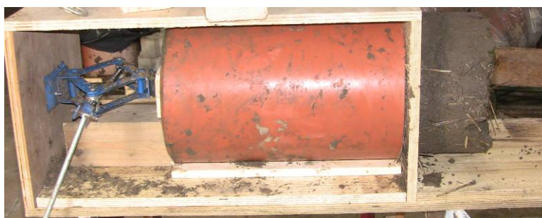
FIGUR 2-10. ANORDNING BENYTTET TIL AT FJERNE DEN STÆRKT VEDHÆFTENDE JORD FRA PVC-RØRENE OG TIL KONTROLLERET OPSKÆRING AF JORDCYLINDRENE I 5 LAG. OPSKÆRINGEN BLEV FORETAGET MED SAV (EN "FUCHSWANS") STYRET AF DEN LODRETTE PLADE I HØJRE SIDE AF BILLEDET.
