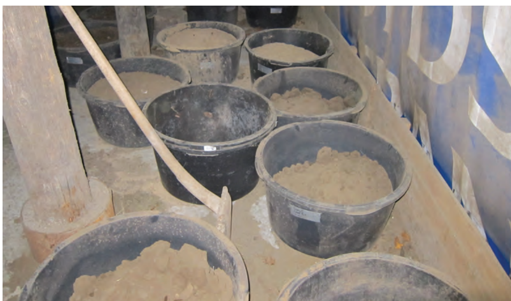
Billede: Talrige kombinationer af aske, vand og vending afprøves i 90 liter baljer. (Simon Skov)
