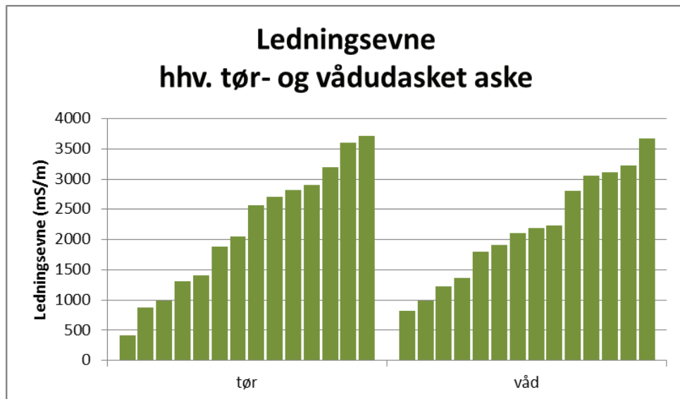
Figur 3. Ledningsevnen af hhv. tør- og vådudasket flisaske.
