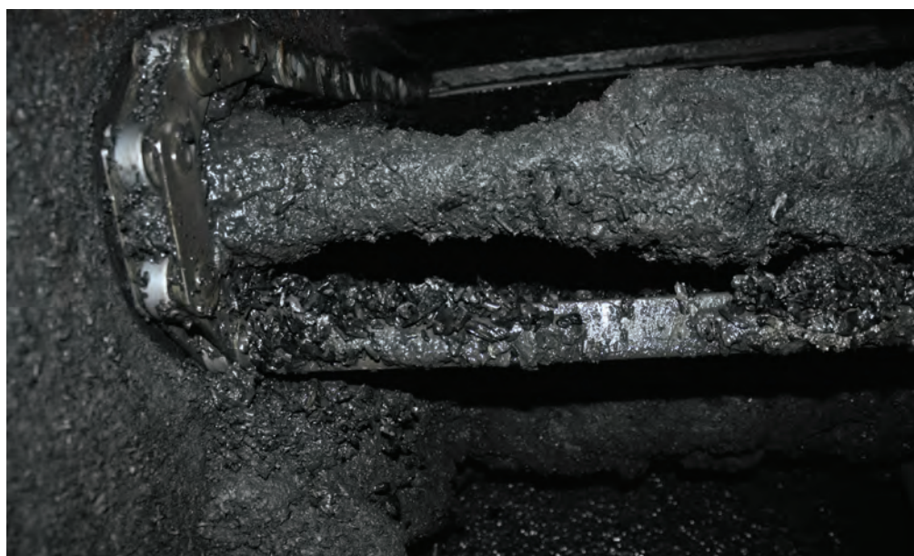
Billede: Kæder trækker skraberne, der bringer asken op af vandkaret i et vådt askesystem. (Simon Skov)
