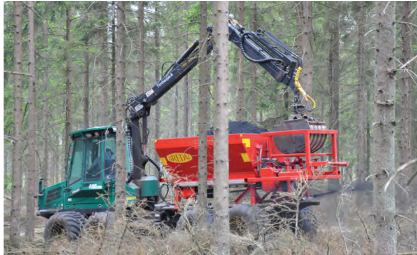
Billede: Udkørselsmaskine med Bredal tallerkenspreder på stellet i stedet for lad. (Simon Skov)
