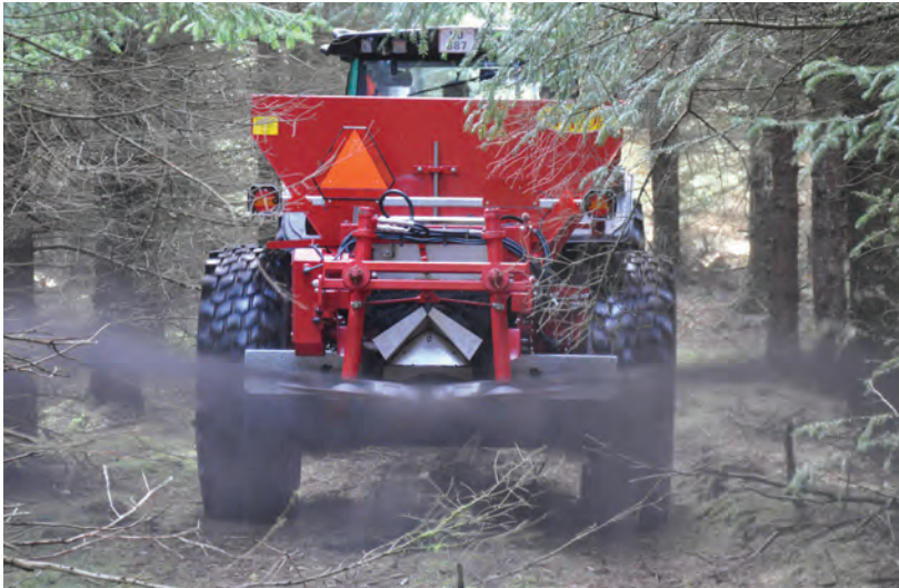
Billede: Aske spredes i tæt bevoksning. Der er talrige muligheder for indstillinger af spredebilledet på en ny Bredal tallerkenspreder. (Simon Skov)
