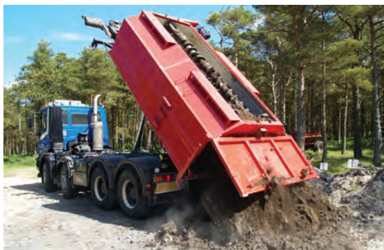
Billede: En fuld askecontainer tømmes under stort besvær, da asken var stivnet omkring sneglen. (Simon Skov)
