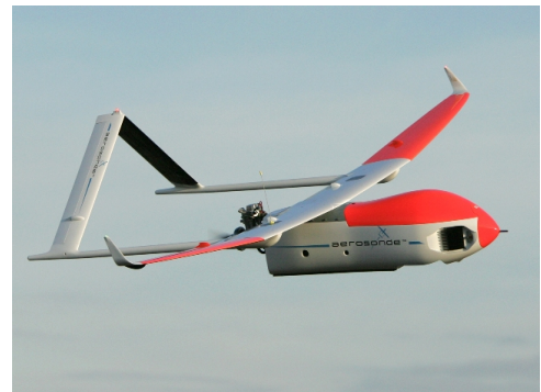
Billede 9: Aerosonde fastvinget drone. Med vingefang på 3.6 meter og række vide på 3000 km er det et meget brugt fly til missioner i Antarktis
