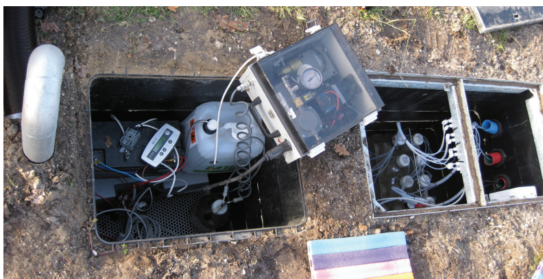
Billede: En nedgravet ethanol-generator driver en vaccumpumpe, der via et system af opsamlingsflasker leverer sug til jordvandssonderne. (Mads Madsen Krag)
