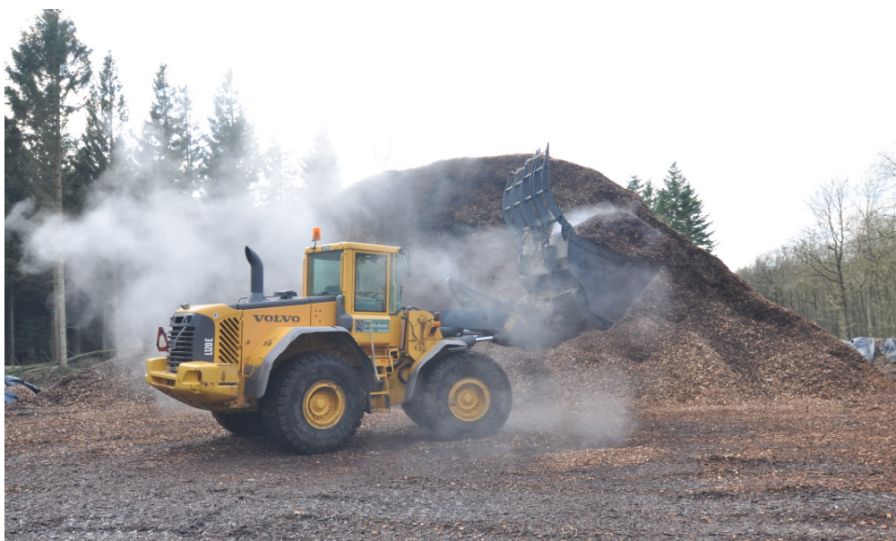
Foto: En stor del af det danske brændselsflis ligger i stak, inden det leveres til et varmekværk. Håndtering af det lagrede flis medfører stor risiko for sundhedsskadelige sporekoncentrationer.
