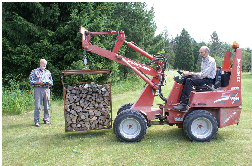
Figur 1. Man ser en ramme ophængt i et åg og med den elektroniske vejecelle indskudt.
