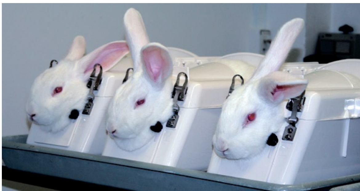
Kanin-pyrogentesten udført som beskrevet i den europæiske farmakopé: Kaninen sidder fastspændt i over fem timer og får lægemidlet indsprøjet i en ørevene. Hvis medicinen er forurenet med pyrogener, får kaninen feber.
