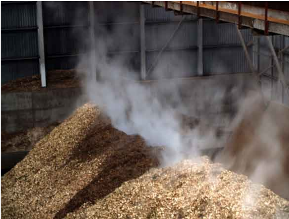
Foto 9. Flislagrene er kraftigt forurenet med skimmelsvampesporer. Ophold bør ske med ånde- drætsværn af P3 kvalitet. Den biologiske aktivitet medfører, at flisen damper.
