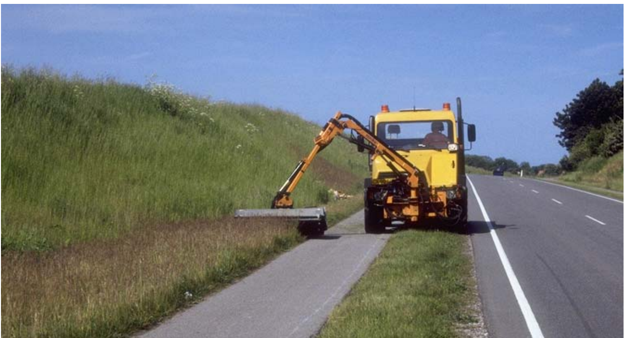
Figur 5. Bagkanten slås ved at der køres på skillerabat og cykelsti.
