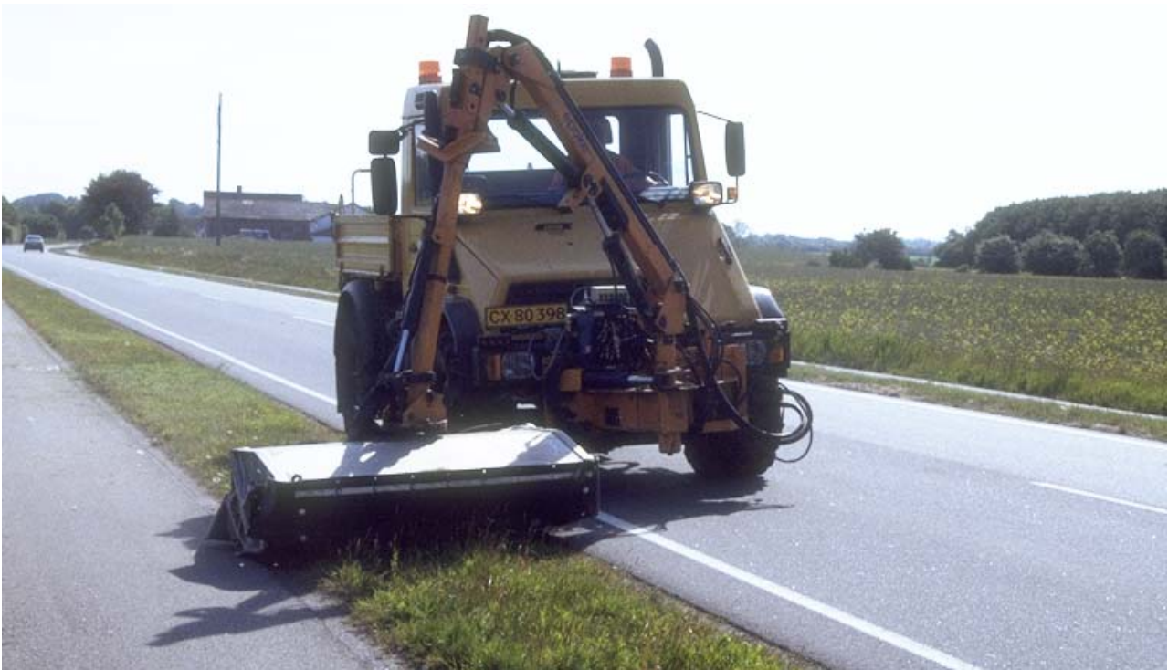
Figur 4. Klipping af skillerabat udføres fra kørebanen.
