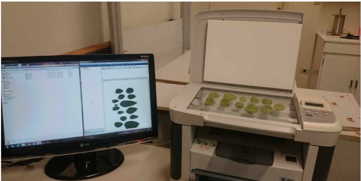
Figura 3. Impressora digitalizadora utilizada para a digitalização dos folíolos de soja e imagem obtida. Laboratório de Irrigação, Universidade Federal de Uberlândia.
