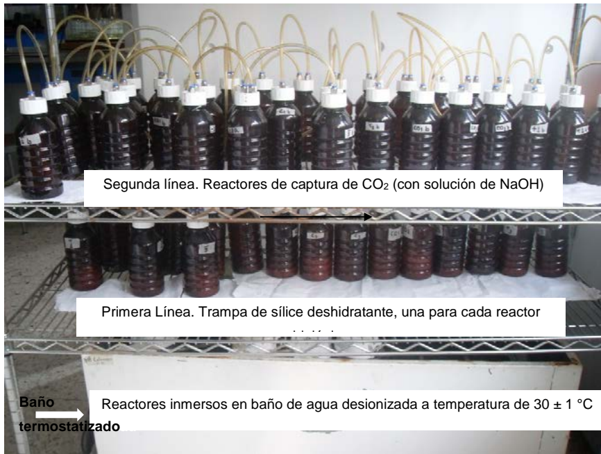
Figura 6.9 Aparatos para evaluar biodegradación de PEAD convencional y oxodegradable con y sin fotooxidación, utilizando la norma ASTM D6691-17 como referente.
