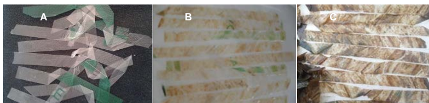
Figura 7.26 Registro fotográfico de la biopelícula en PEAD oxodegradable fotooxidado: (A) sin exposición; expuesto en ambiente natural de agua dulce: (B) 30 días, (C) 180 días.
