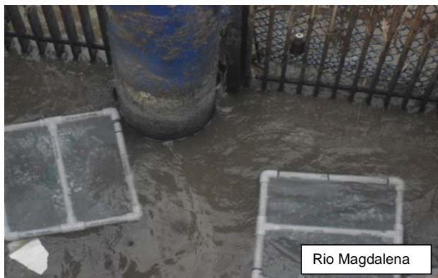
Figura 6.8 Probetas flotantes sobre el agua dulce del Río Magdalena (Barranquilla, Colombia).
