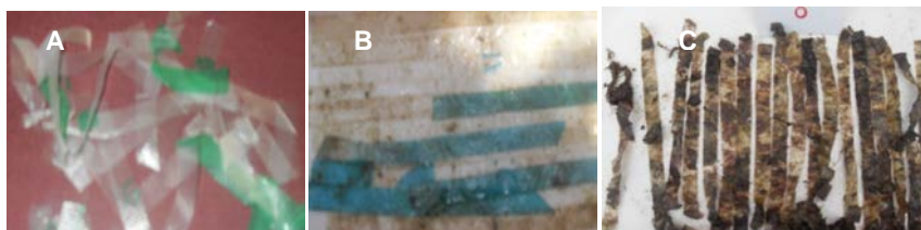
Figura 7.7 Registro fotográfico de PEAD oxodegradable: (A) sin exposición; expuesto en ambiente marino: (B) 30 días, (C) 180 días.
