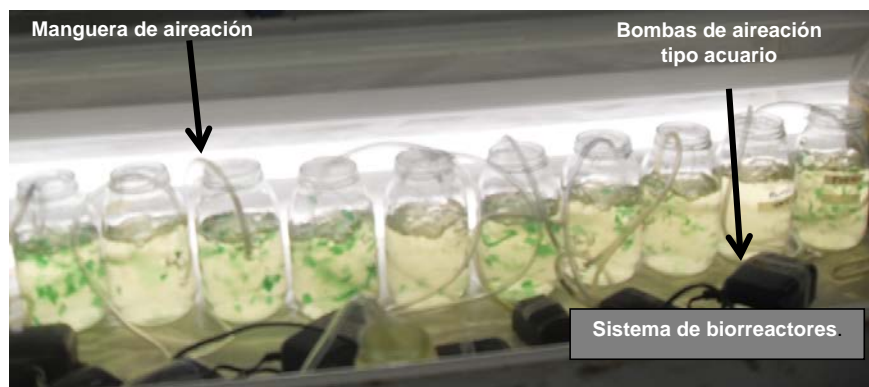
Figura 6.13 Sistema de biorreactores de prueba para evaluar ecotoxicidad de los plásticos utilizando Chlorella sp como organismo de prueba.
