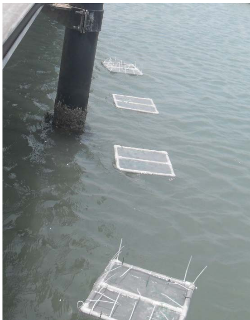
Figura 6.7 Probetas flotantes sobre el agua marina en Puerto Velero (Atlántico, Colombia).
