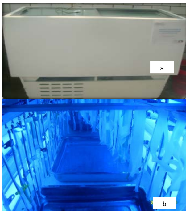
Figura 6.4 (a) Cámara de intemperismo; (b) Materiales expuestos para oxidación con radiación UV dentro de la cámara de intemperismo.
