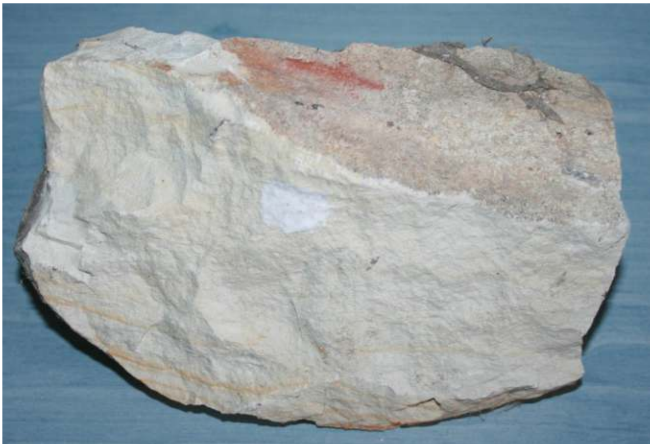
Obrázek 4 Žatec, stavební materiál - opuka, foto, 2008.
