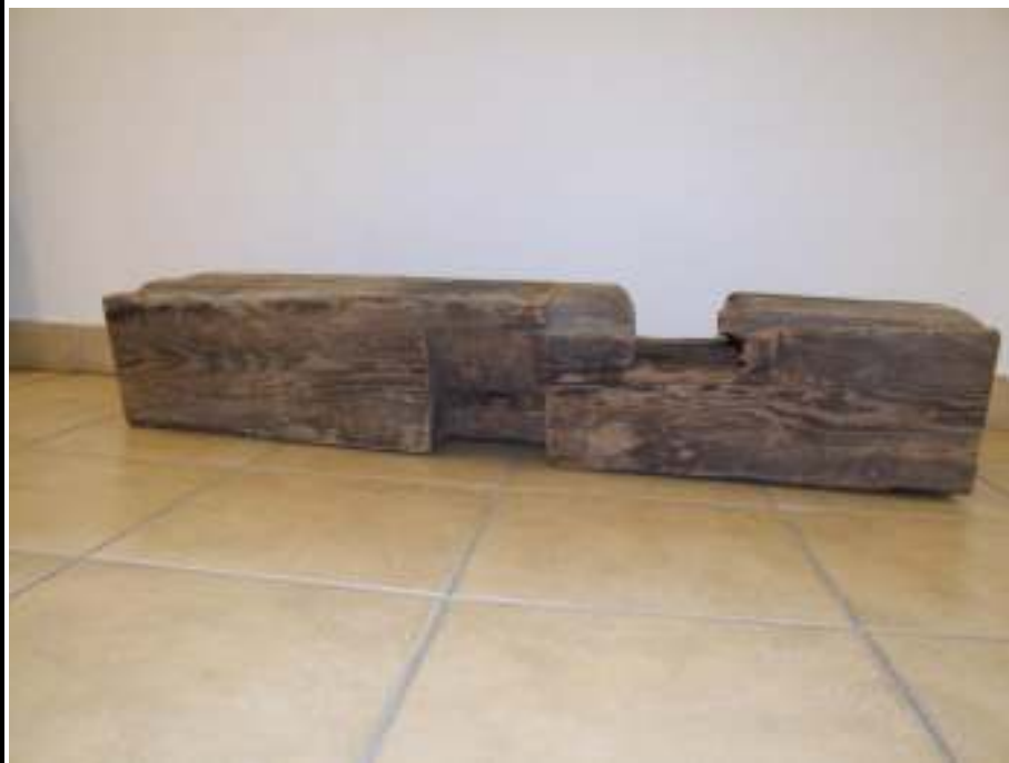
Pohľad na pomúrnicu s dlabmi.
