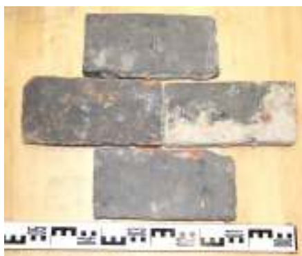
Obrázek 22 Ostrava - Moravská Ostrava, městský dům čp. 1111, dlaždice z půdy složené do původního vzoru, konec 19. století, foto, 2015.
