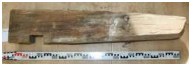
Obrázek 17 Odry - Loučky, hospodářská budova u vodního mlýna Wesselsky, část krokve s pohledovým zhlavím.
