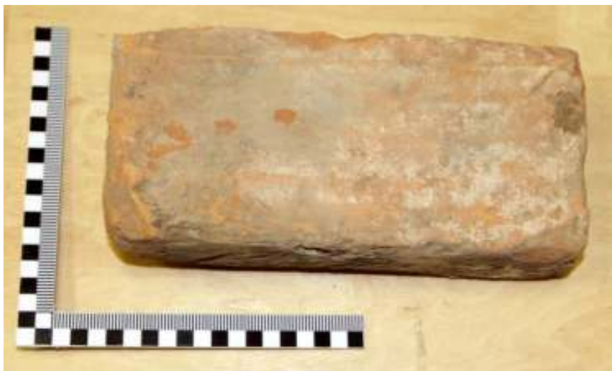
Obrázek 5 Opava, minoritský klášter, cihla strukturovaná tahy prstů, foto, 2015.
