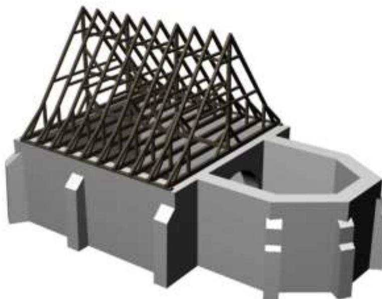
Obrázek 16 Klimkovice, kostel Nejsvětější Trojice, model krovu lodi, vytvořil Jan Baroš, 2013.
