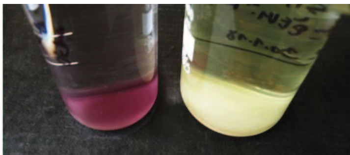
Obrázek 28: Porovnání odpadní křemeliny s nanočásticemi zlata (vlevo) a filtrační křemeliny s Au prekurzorem (vpravo) po 24 hodinách
