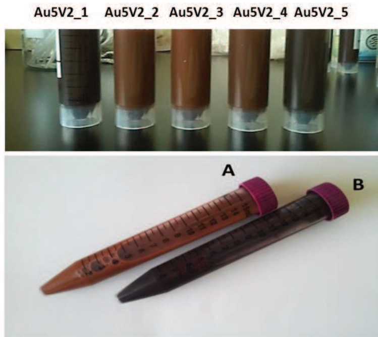
Obrázek 42: Snímek nahoře ilustruje 5 vzorků fyto-syntetizovaných nanočástic zlata z květů a listenu lípy, snímek dole ilustruje Au koloid připravený smícháním prekurzoru s A) výluhem z vijanů a B) výluhem z listenů
