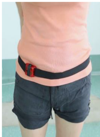
Slika 1: prikaz pravilne namestitve pospeškometra okoli pasu
