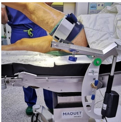
Slika 9: Nova električna opornica (lasten vir)
